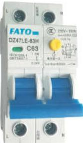
DZ47LE-63/1P+N一体式剩余电流动作断路器(简称剩余电流动作断路器)为整体式(双手柄)、小型化、1P+N剩余电流动作断路器，适用于交流50Hz、额定电压230V，额定电流至63A的线路中，作为负载线路的剩余电流(触电)、过载和短路保护。也可作为不频繁接通、分断和转换之用。该系列产品具有分断能力高、附件适用性强、体积小、重量轻、外形美观和使用方便等优点。
