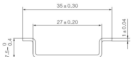
图2 安装轨尺寸
