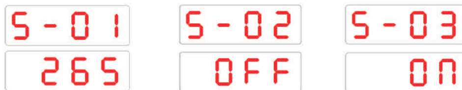
图4: 过压值、过压告警、过压保护设置
