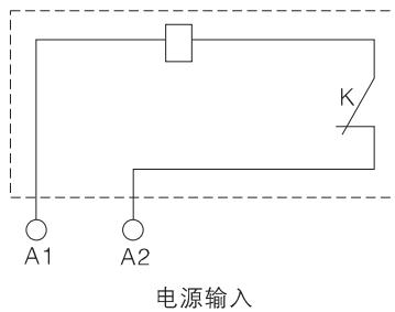
K:分励脱扣器内部与线圈串联的微动开关为常闭触头，当断路器分闸后，该触头自行断开，合闸时闭合。
