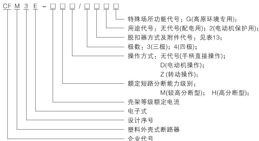
选择特殊场所 CFM3E 系列塑料外壳式断路器可满足光伏、风电、高原和低温至-40℃环境条件下使用，符合GB/T 20645《特殊环境条件 高原用低压电器技术要求》，通过标准规定的相关试验。
