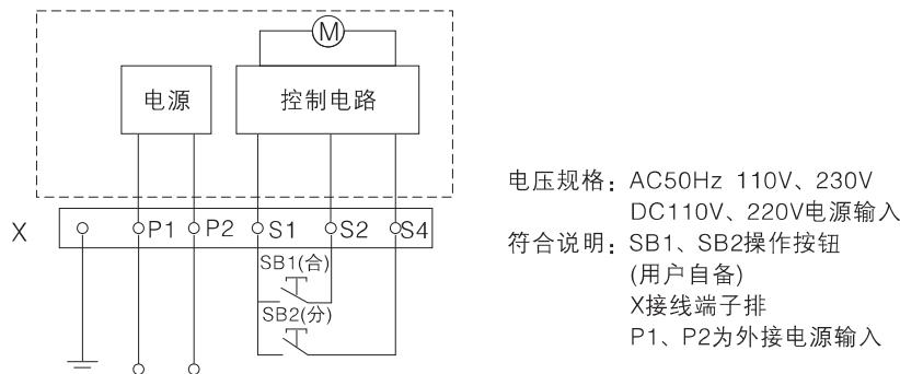
注: 断路器脱扣跳闸后, 电动操作机构必须先使断路器再扣, 然后才能合闸
