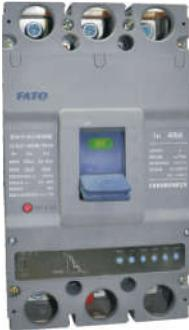
CFM3E系列电子式塑壳断路器(以下简称断路器)是本公司高新技术产品。该产品设计先进、性能可靠、技术指标高；外形美观、体积小、采用了微电子技术，具有智能化过电流保护功能。该断路器适用于交流50Hz、额定绝缘电压690V，额定工作电压至690V、额定电流至800A的电力系统中，用来分配电能和保护线路及电源设备免受过载、短路、欠电压等故障的危害，也可用来控制电动机的不频繁操作。该断路器具有隔离功能，符号为“—／—”。
