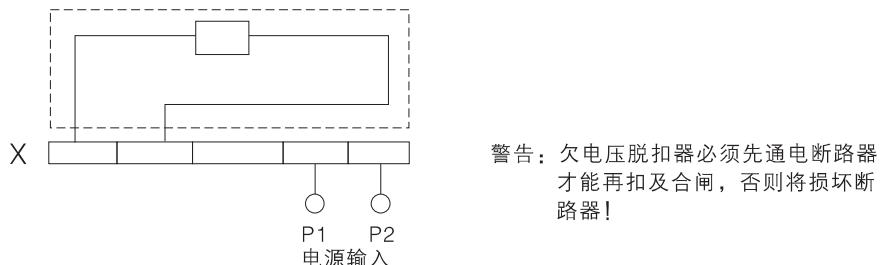
外挂欠电压模块接线图(虚线框内为断路器内部接线图)
