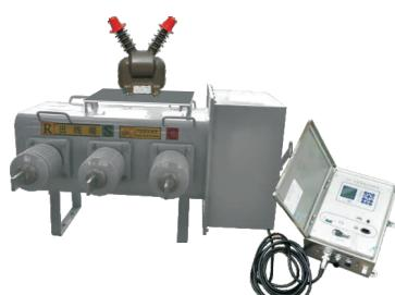
LW34-12—二次融合SF6断路器，是本公司根据国家电网最新标准《10kV一体化柱上变台和配电一二次成套设备典型设计及检测规范》要求，融合行业领先的电子式电压传感器、电流传感器、电能计量模块、高速故障暂态录波等先进技术的柱上成套断路器设备。该成套设备可不依赖配电自动化主站和通信，实现“自适应综合型就地自动化”功能，通过短路/接地故障检测技术、无压分闸、故障路径自适应延时来电合闸等控制逻辑，自适应多分枝多联络配电网架结构，实现单相接地故障的就地选线、区域定位与隔离，通过两次重合闸实现故障区域隔离和非故障区域恢复供电，是配电自动化的首选产品！
