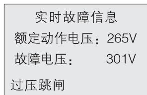
图10 过欠压跳闸界面：
