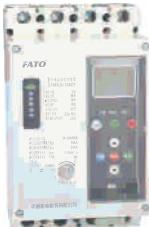
CFM3LE(CY)系列电子式剩余电流断路器的额定绝缘电压为1000V，适用于交流50Hz，额定电压400V，额定电流至630A的三相四线中性点直接接地( TT )配电网络。用于提供间接接触保护；防止因设备绝缘损坏，产生接地故障电流而引起的火灾危险；并可用来分配电能和保护线路的过载和短路；对线路的过压、欠压、缺相具有保护功能。
