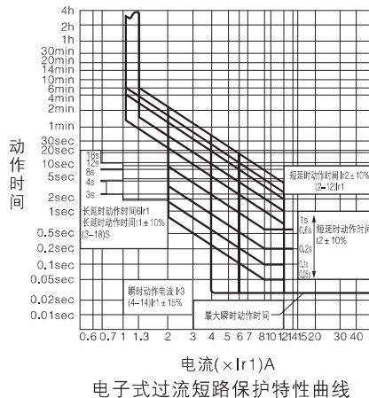
电子式过流短路保护特性曲线
