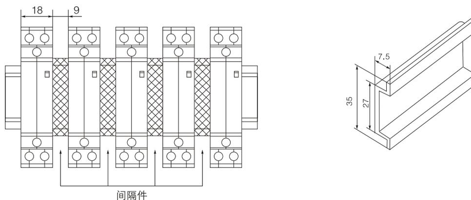
注：使用二极产品当接触器间、接触器与断路器间紧靠安装时，产品间必须安装间隔片，以利于散热；当配电箱内温度过高时，接触器需要降容使用。
